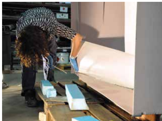
16 Zatvaranje rupa epoksidnom smolom Araldite 2011 armiranom tkaninom od staklenih vlakana (foto: S. M. Sunara, 2014.)
