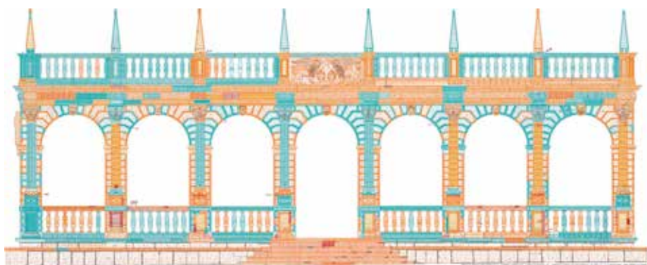
2 Konzervatorsko-restauratorska dokumentacija – mapiranje vrste kamena i klesarskih alata na južnom pročelju lože (izradila: LAIRA s.r.l. 2012.)
