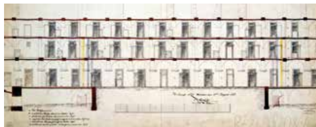
22a Uzdužni presjek kroz sjeverno krilo samostana. Nacrt Johanna Polivke iz 1852. godine s ucrtanim promjenama vrata ćelija (Ministarstvo kulture, Uprava za zaštitu kulturne baštine).
